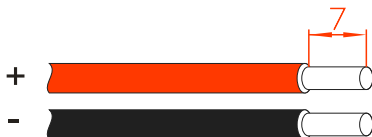
Figura 3-16 Ilustração da remoção do cabo de entrada CC (unidade: mm)
