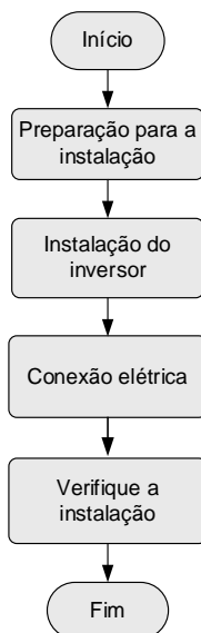
Figura 3-1 Processo de instalação
