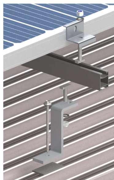
MONTAGEM EXPLODIDA DO SUPORTE E GRAMPO FINAL
