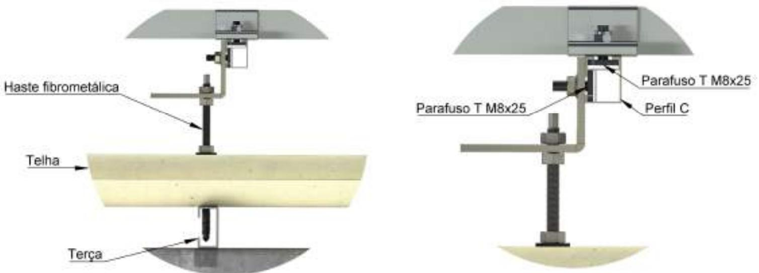
Detalhe "B" vista da fixação da haste com perfil híbrido
