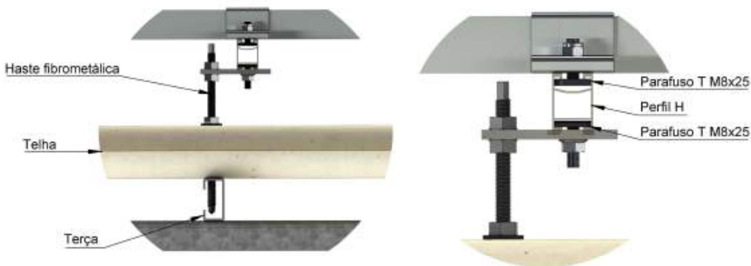
Detalhe "A" vista da fixação da haste
