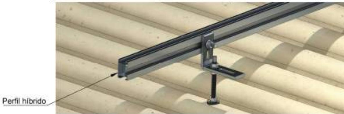
**Imagem ilustrativa haste fibrometálica com perfil híbrido fixado por baixo**
