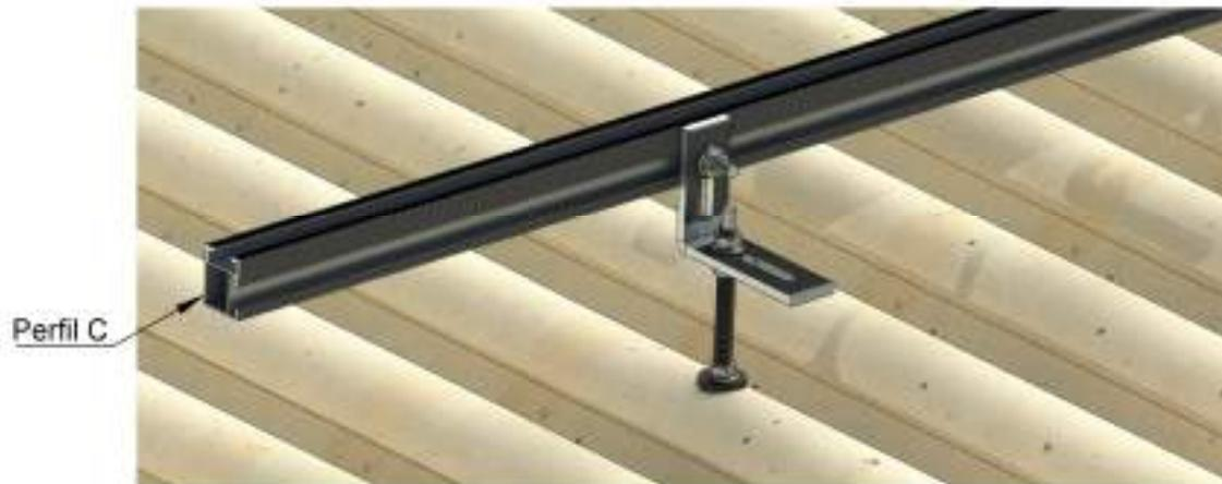
**Imagem ilustrativa haste fibrometálica com perfil híbrido fixado pela lateral**
