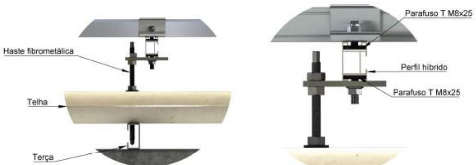
Detalhe "D" vista da fixação da haste com perfil híbrido
