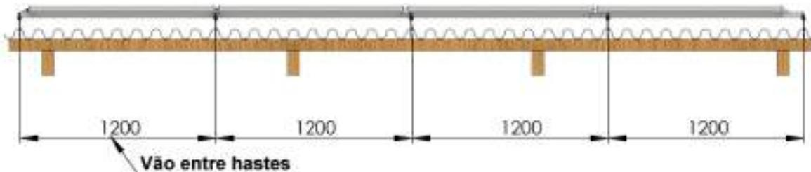
No caso de junção de duas estruturas a primeira haste é colocada na extremidade do perfil assim começa o distanciamento de 1066mm entre vãos de cada haste como na ilustração a baixo
