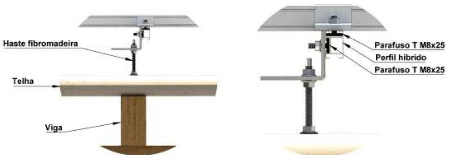
Detalhe "C" vista da fixação da haste
