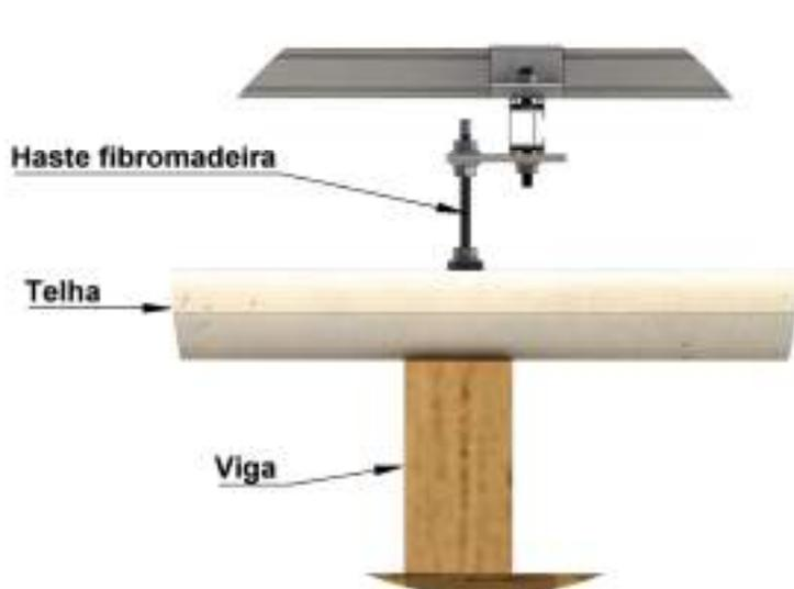
Detalhe "D" Vista da fixação da haste
