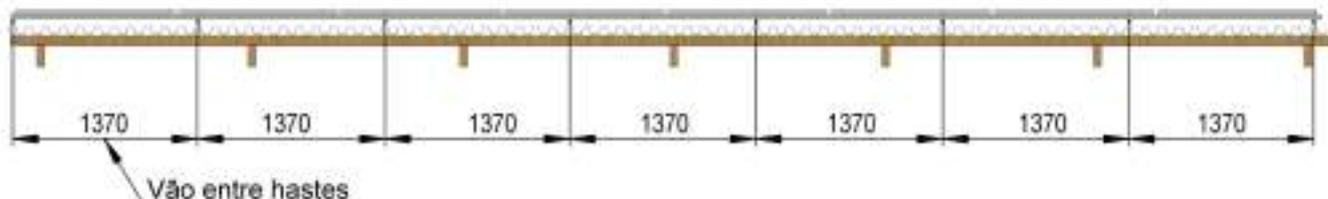
No caso de junção de duas estruturas a primeira haste é colocada na extremidade do perfil assim começa o distanciamento de 1309mm entre vãos de cada haste como na ilustração a baixo
