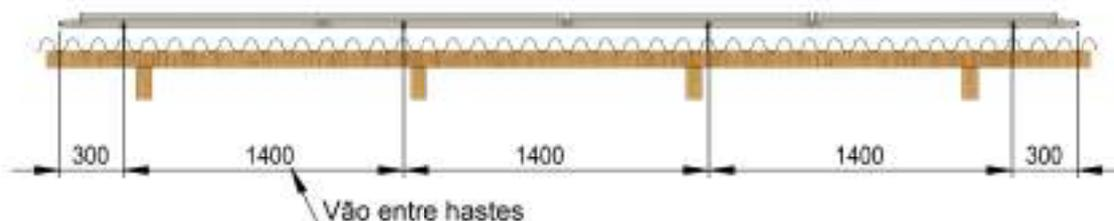
No caso de junção de duas estruturas a primeira haste é colocada na extremidade do perfil assim começa o distanciamento de 1370mm entre vãos de cada haste como na ilustração a baixo
