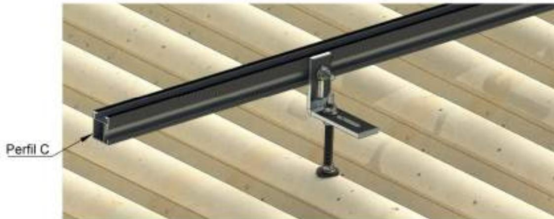
**Imagem ilustrativa haste fibromadeira com perfil híbrido fixado pela lateral**
