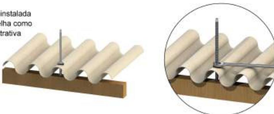
Após fixada aperte a porca contra a borracha de vedação para vedar o telhado
