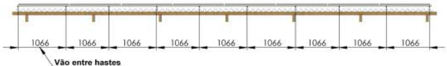
No caso de junção de três estruturas a primeira haste é colocada na extremidade do perfil assim começa o distanciamento de 1028mm entre vãos de cada haste como na ilustração a baixo
