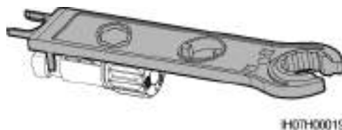
Figura 5-14 Remoção de um conector CC
