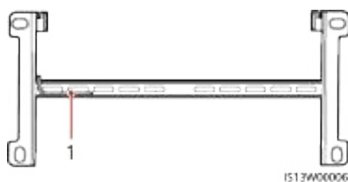
Figura 4-9 Posição para a vinculação da chave de boca Torx
