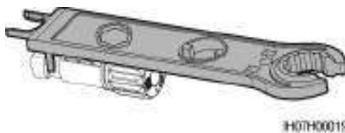
Figura 5-14 Remoção de um conector CC
