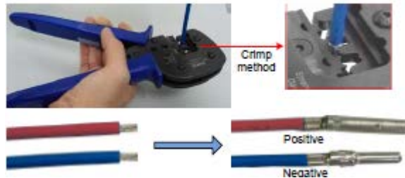
Figura 3-9: Crimpagem de terminal
