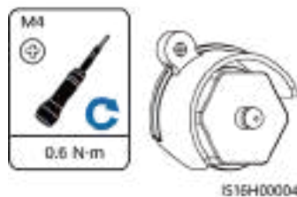
Figura 5-39 Instalação de componentes antifurto para o Smart Dongle
