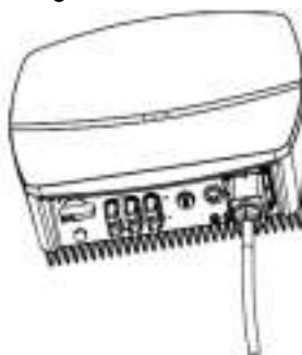
Figura 5.121 Aperte a tampa protetora da interface CA e o trava
