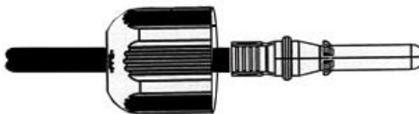
Figura 3-17 Crimpe o terminal de metal negativo
