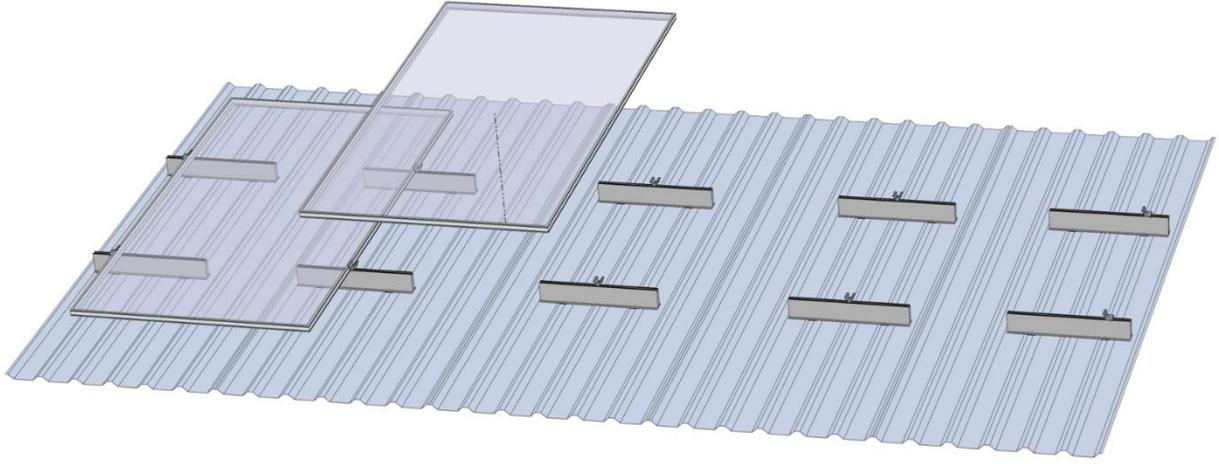
As placas devem ser colocadas uma por vez, após o posicionamento das mesmas, deve-se apertar as porcas dos Grampos para a correta fixação.
