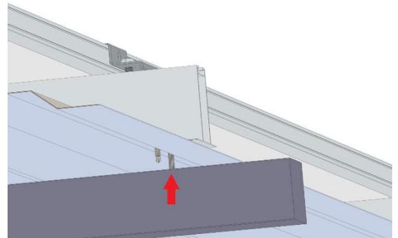
Obs. 03: Se na fixação dos Mini Trilhos no telhado houver algum ponto de estrutura do telhado que esteja alinhado a aba do perfil, utilizar os parafusos de 4\"/>
