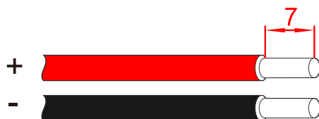
Figura 3-16 Desencape os fios de entrada do cabo fotovoltaico (unidade: mm)
