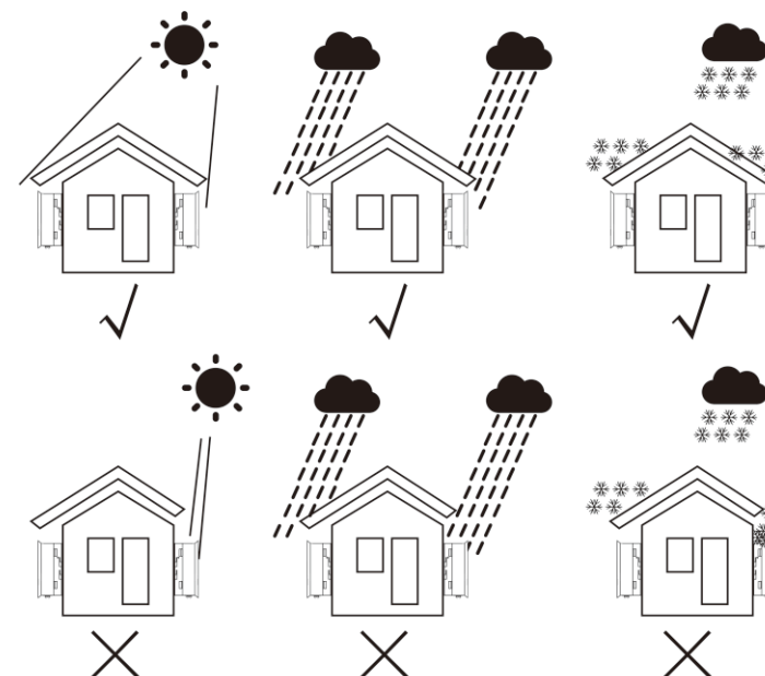
▲ Figura 5.1 Posição de instalação recomendada
