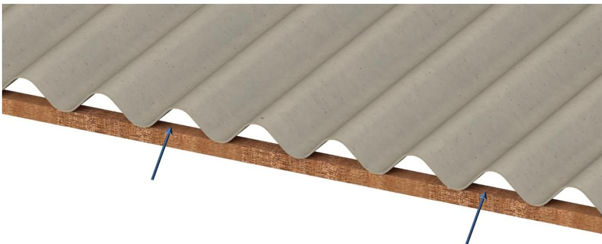
3º Faça um furo na água alta da telha, e insira o parafuso prisioneiro de forma que o mesmo atarraxe na viga ou caibro. (OBS: lembre-se de informar ao representante da equipe Fixa Solar o material estrutural de seu telhado, seja madeira ou aço, para que possamos encaminhar o parafuso prisioneiro adequado)
