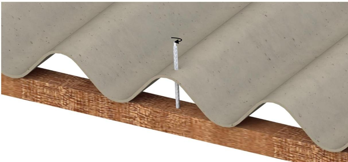
4º Após parafusar o mesmo sobre a estrutura, insira a borracha de vedação encostando a mesma na superfície do telhado.
