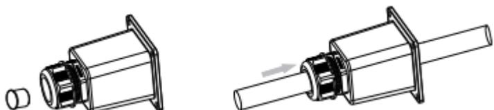
Passo 3: Remova a capa do cabo e descasque 60~65mm, e desencape o isolamento do fio por 7-10mm.
