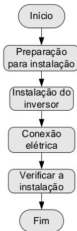
Figura 3-1 Processo de instalação
