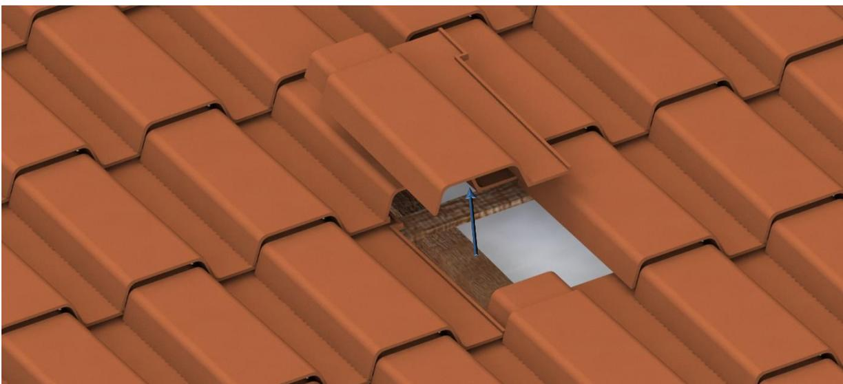
3º Defina o local de posição do perfil Z de forma que o mesmo se sobreponha na parte alta da telha. Se necessário utilize a regulagem da base para que a posição do gancho se sobreponha a parte alta da telha.
